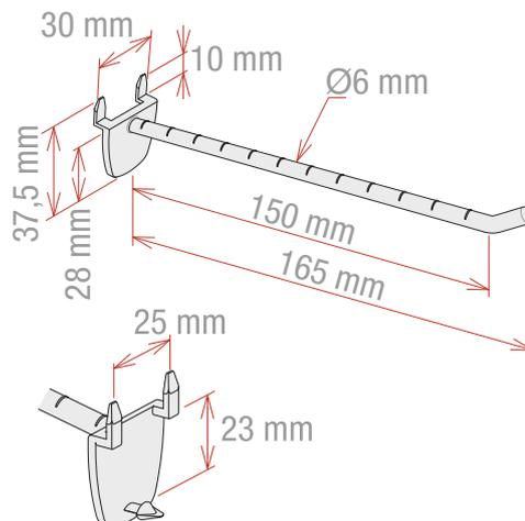
Auto-perforante avec pointes de perforation pour éviter la découpe des trous sur le display.
